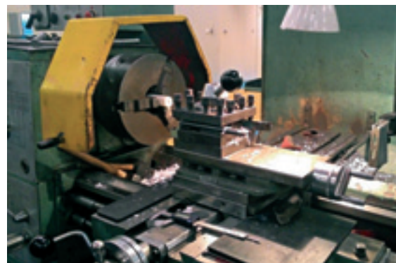
Tokarnia do wykonywania tulei teflonowych prowadzących listwę zębata.
