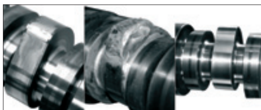
Krywka wałka rozrządu przed, w trakcie i po regeneracji.
