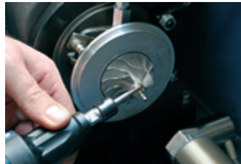
Korekta masy na nakrętce rdzenia za pomocą frezu zamocowanego do ręcznej szlifierki.
