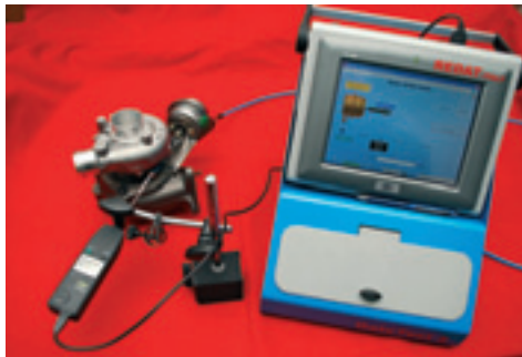
Przyrząd GateTest do kontroli oraz korekty nastaw zmiennej geometrii turbosprężarki.
