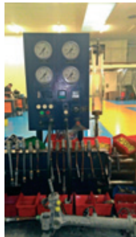
Stanowisko diagnostyczne do przekładni kierowniczych (sprawdzanie wymaganych ciśnień).
