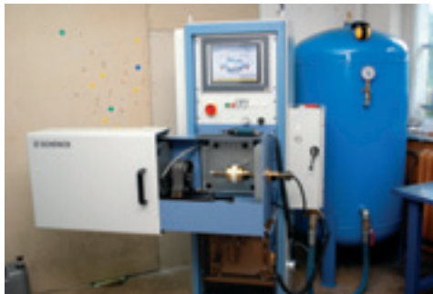
Wyważarka do wyważania wimików turbosprężarek, pracująca przy prędkości 200.000 obr./min.
