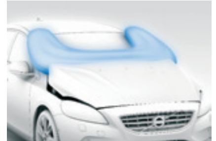
Fot. 10. Poduszka powietrzna dla pieszych na przedniej masce samochodu (patent firmy Volvo).
