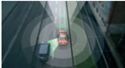
Fot. 4. Kamera 360° – czujniki i kamery dookoła samochodu, które stale monitorują całe otoczenie auta.
