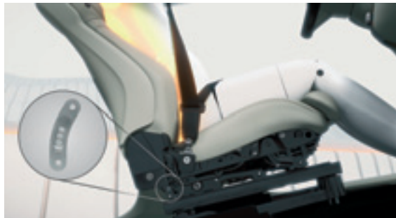
Fot. 3. System WHIPS (ang. Whiplash Protection System) – fotel z zagłówkami chroniącymi podręczki w przypadku najechania na tył auta.
