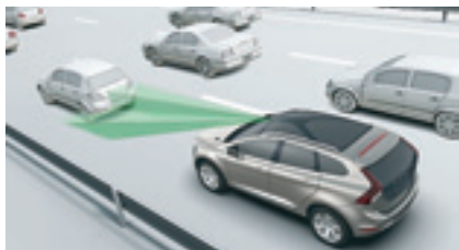
Fot. 11. System City Safety – automatyczne wyhamowanie samochodu poprzez wykorzystanie technologii laserowej.
