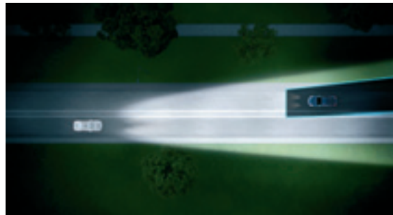
Fot. 6. Inteligentny system sterowania wiązką światła drogowych (High Beam Control).
