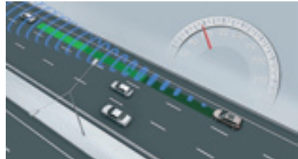
Fot. 5. ACC (Adaptive Cruise Control) – aktywny tempomat i system ostrzegania kierowcy z funkcją awaryjnego hamowania.
