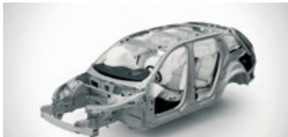
Fot. 2. Zestaw poduszek powietrznych współczesnego samochodu. (Poduszki kolanowe, żółte, boczne i kurtyny powietrzne).
